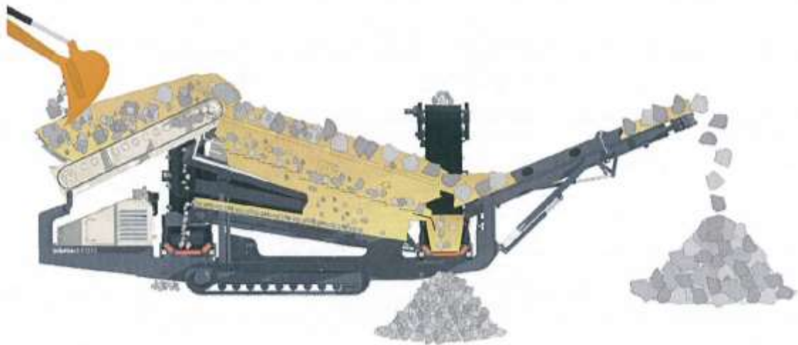
Figure 4 : Schéma de fonctionnement du groupe mobile de traitement
